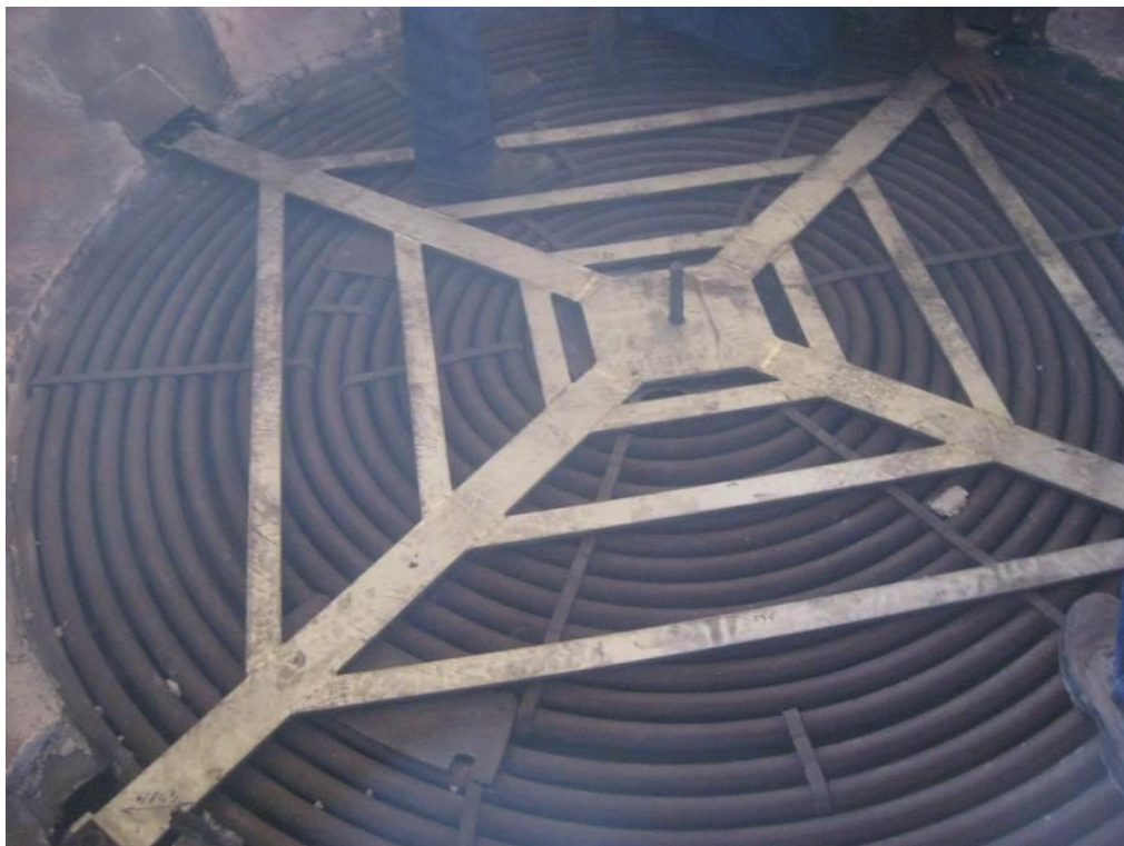
Foto 3: Estructura soporte en fondo del Reactor R1101 donde se soporta la Canasta.
