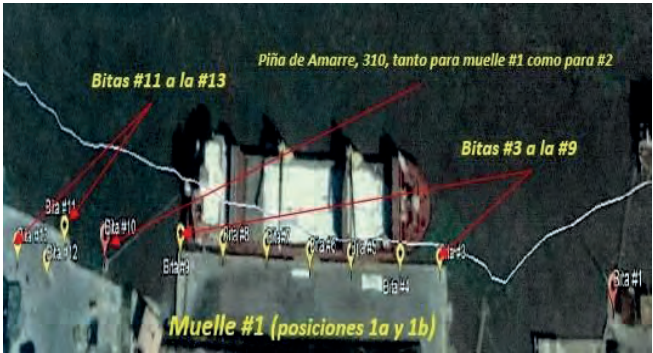
Muelle Terminal Marítimo SPMCV; Vista general distribución bitas y piña de amarre, en muelle #1.
