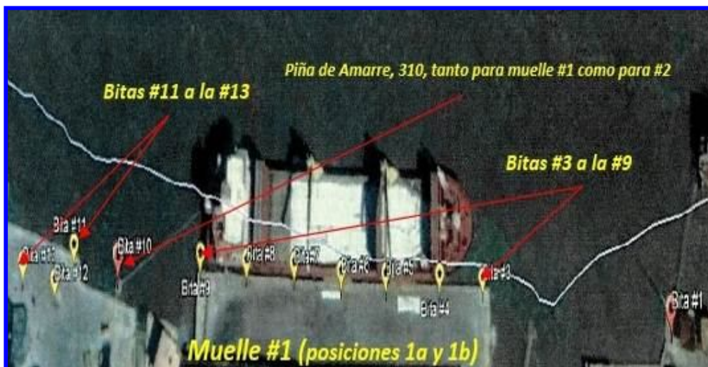
Muelle Terminal Marítimo SPMCV; Vista general distribución Bitas y Piña de Amarre, en Muelle #1
